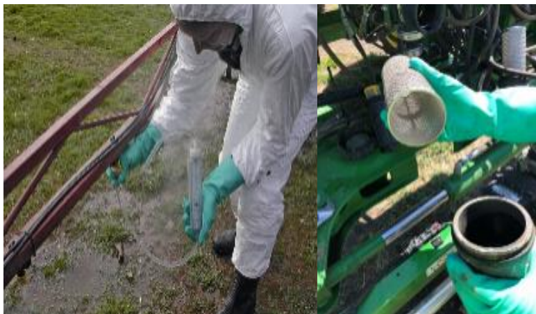
រូបភាពទី១៩ ៖ បង្ហាញពីការត្រួតពិនិត្យឧបករណ៍បាញ់ថ្នាំមុនពេលប្រើប្រាស់
