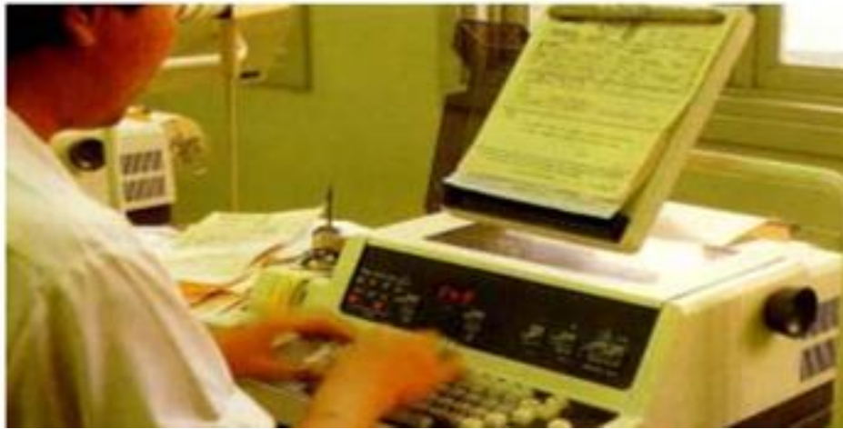
រូបភាពទី៣.១៤ គ្រឿងទូរលេខប្រភេទបោះពុម្ពបាន
